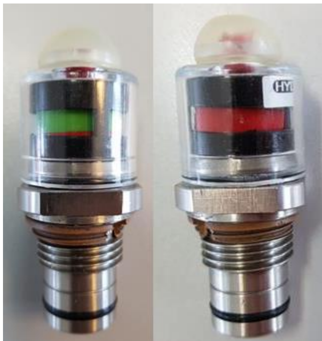
Links een indicator voor een niet-verstopt filter; rechts een indicator voor een verstopt filter.
