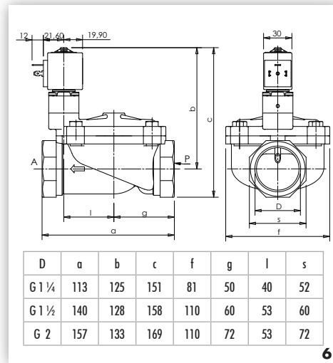
3/2 SOLENOID VALVES DIRECT ACTING - 3/2-WEGE-VENTILE DIREKT GESTEUERT
