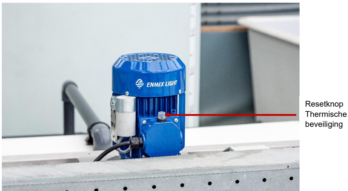
Figuur 2 Positie thermische beveiliging
