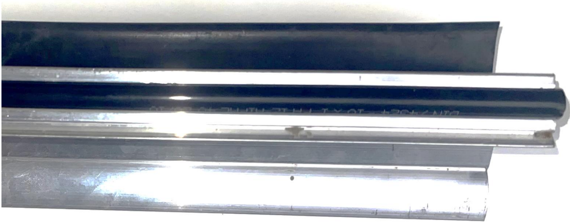
Figuur 21 Nylon slang ter bescherming van steundraden
